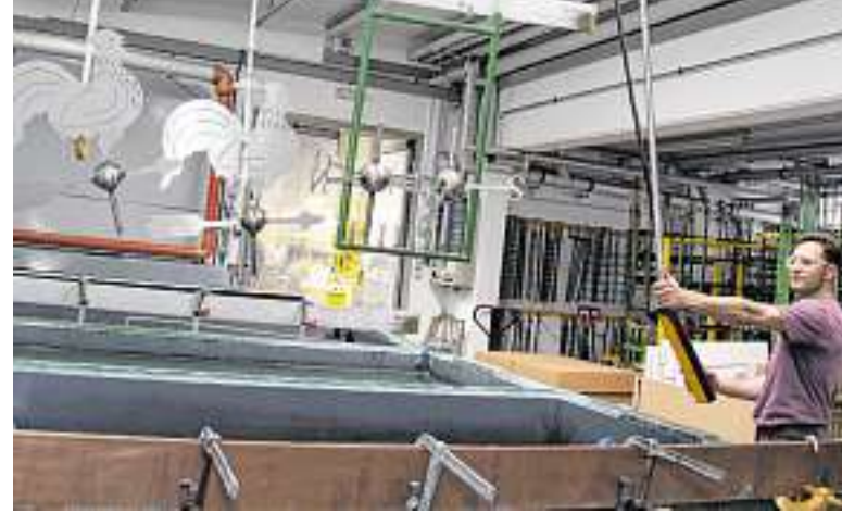
Abtauchen ins Becken: Bei der Firma Bredt wird ein elektrochemisches Veredelungsverfahren angewendet.
