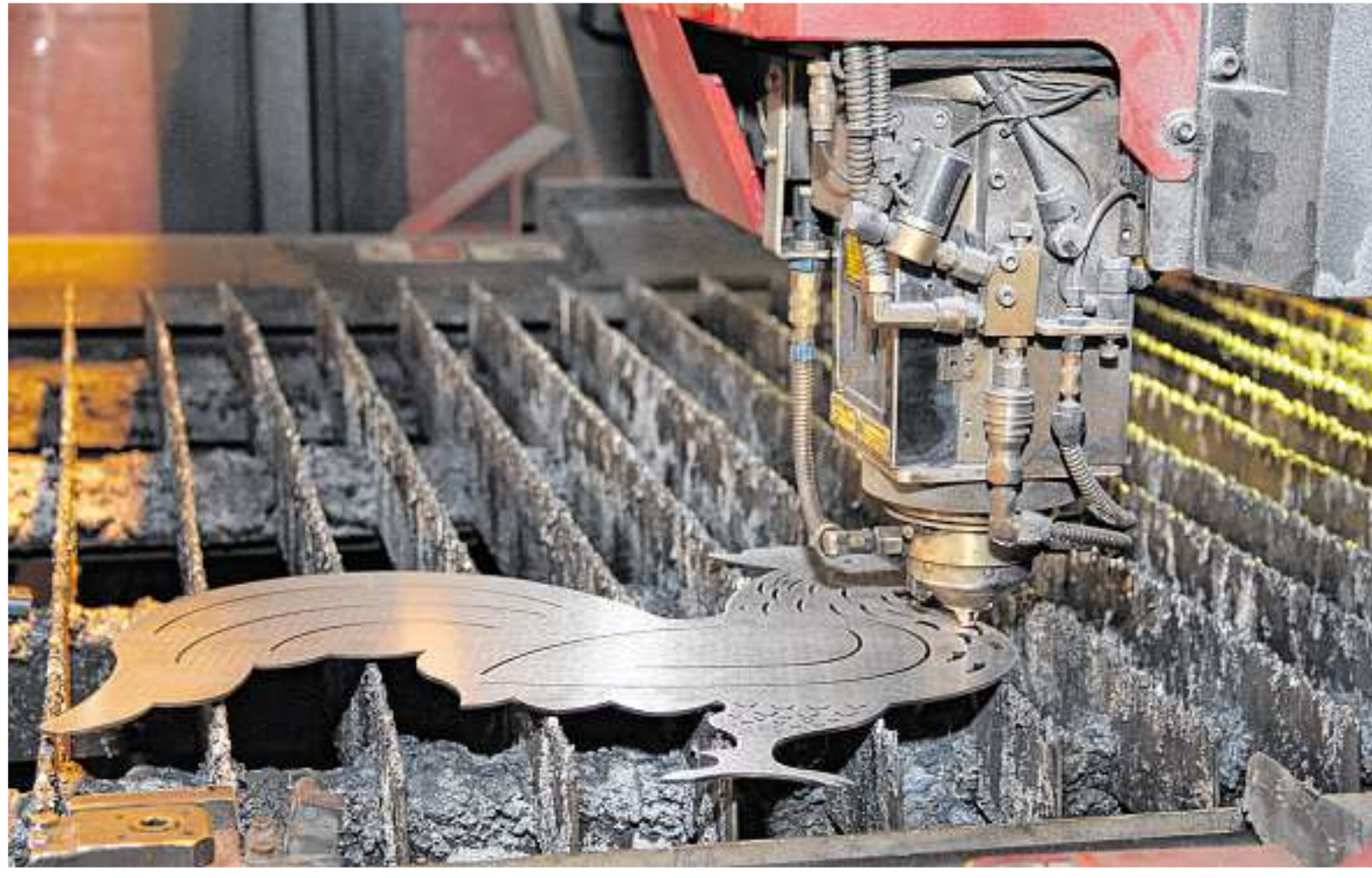
Millimeterarbeit nach Vorgaben des Designs: Per Laser wird der Wetterhahn aus Edelstahlblechen herausgeschnitten.
